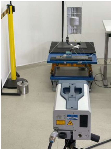
Abbildung 9: Messaufbau mit 1D-Laserscanner und automatischer Hammeranregung
