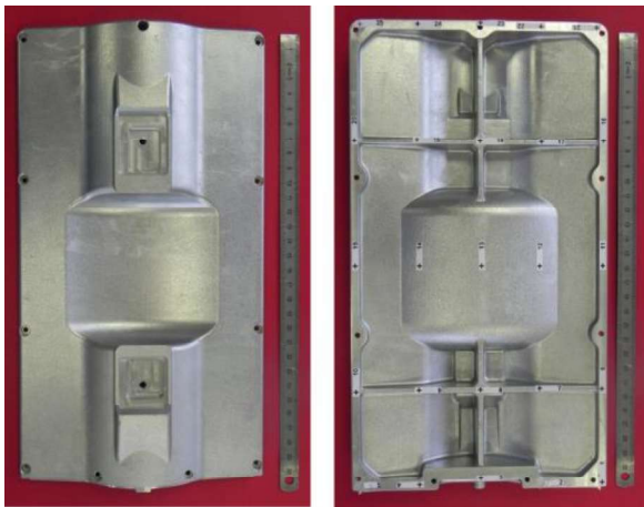
Abbildung 5: Abdeckplatte ( \approx 860 \text{ g} , \approx 305 \times 165 \times 33 \text{ mm} )
